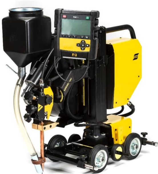
Versión SAW de cuatro ruedas del Versotrak
