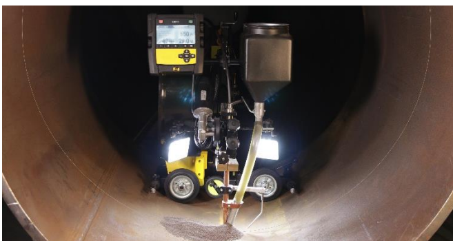
Versotrak con tres ruedas dentro de una tubería y con kit de lámpara LED opcional
